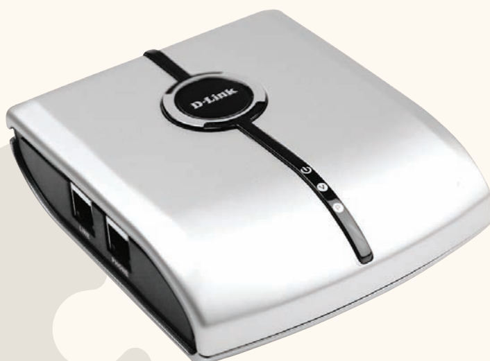
D-Link DPH-50U. Один из лучших USB-шлюзов для Skype. Хотя разъемы расположены крайне неудобно
