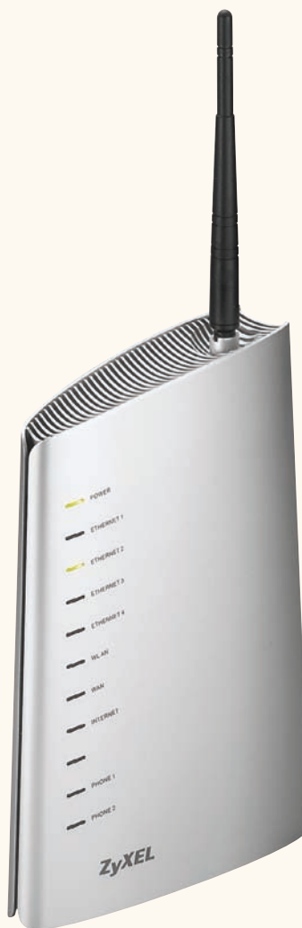
ZyXEL P-2302HWUD. Мощный интернет-центр для подключения по выделенной линии Ethernet с точкой доступа Wi-Fi 802.11g, сервером приложений, DECT-станцией и адаптером IP-телефонии. Для полного счастья не хватает только ADSL-модема
